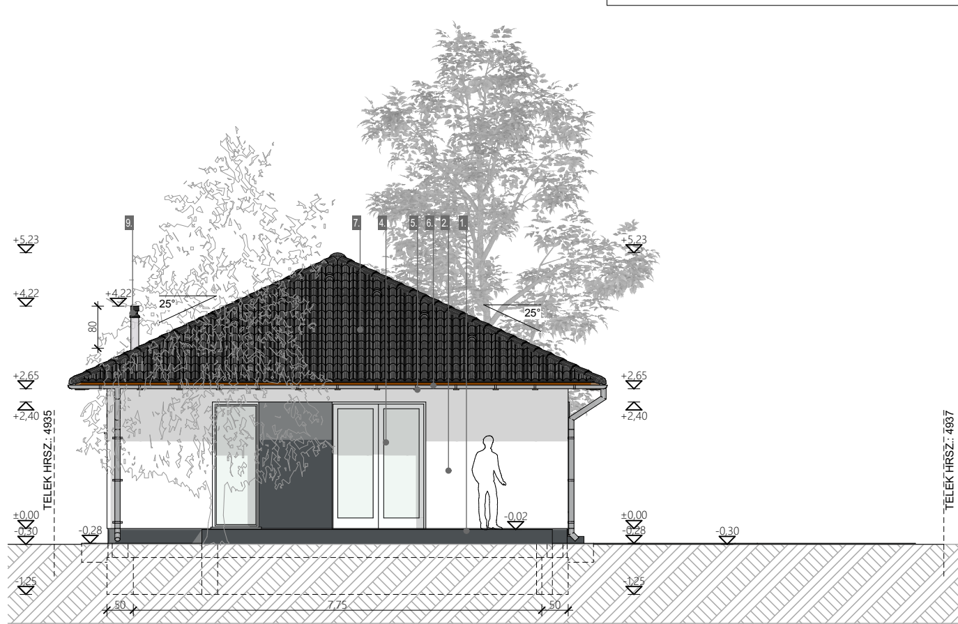
NYUGATI HOMLOKZAT (M=1:100)
